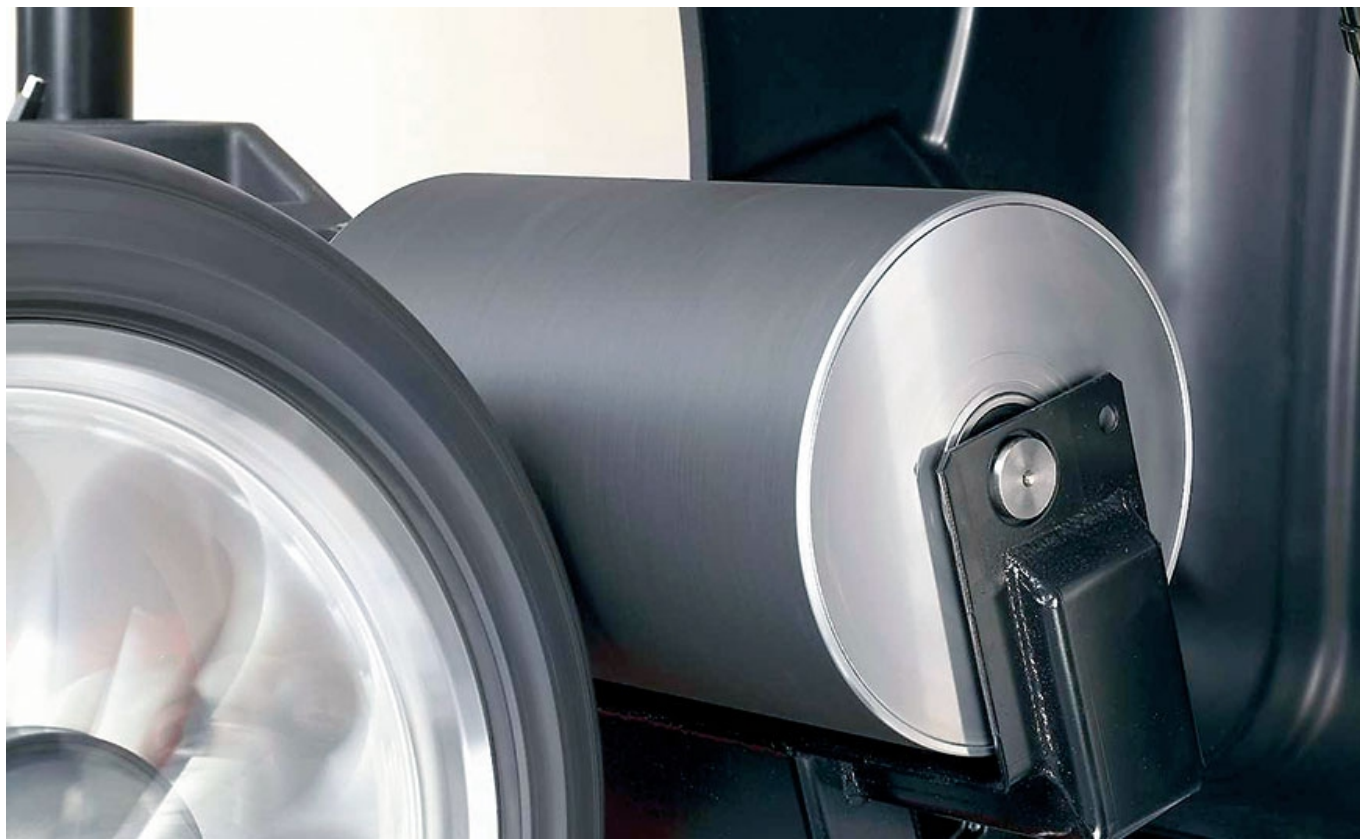
Rys.7. Rolka dociskana do opony umożliwiającą pomiar siły promieniowej zastosowana w wyważarkach firmy Hunter z funkcją testu drogowego (źródło: Hunter).
