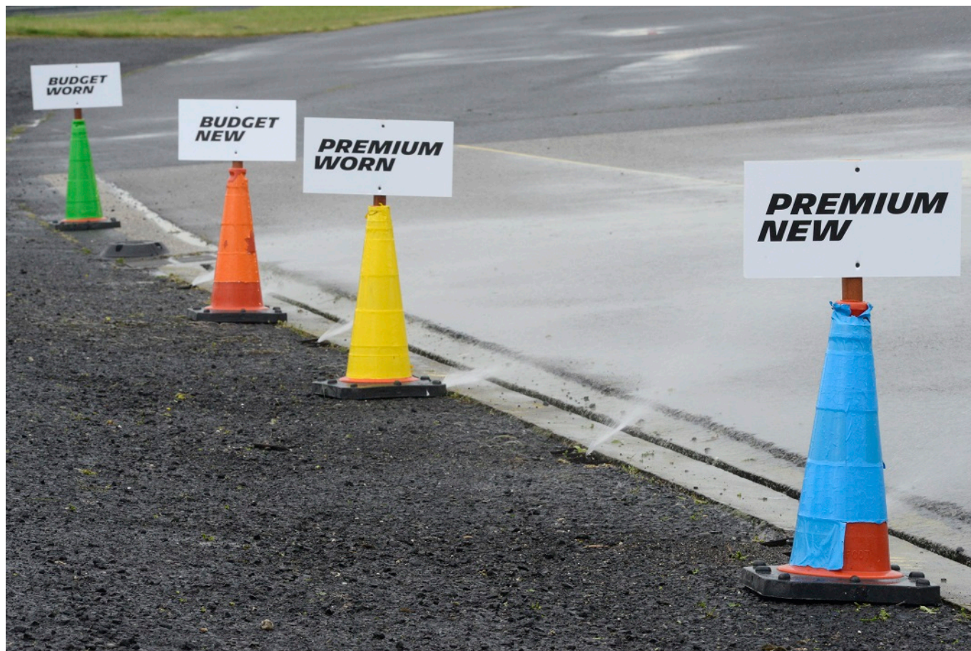
Zdjęcie 1 – Wyniki testu hamowania na mokrej nawierzchni. Najkrótszą drogę hamowania uzyskała nowa opona premium, kolejne miejsca należały odpowiednio do używanej opony premium, nowej opony budżetowej, używanej opony budżetowej.
