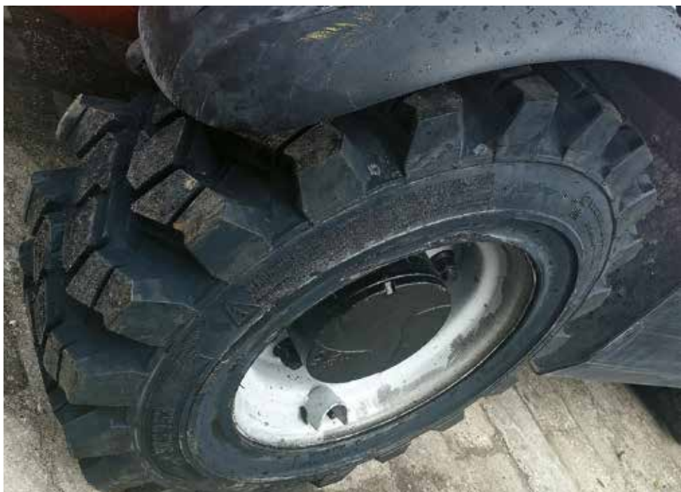
Opona MPT na ładowarce Manitou z wzorem bieżnika przeznaczony na twarde podłoże
